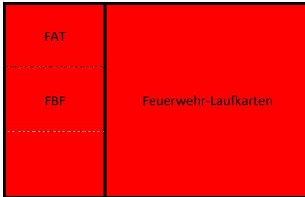
Die Erstinformationsstelle ist so auszuwählen, dass die Bediengeräte und die Feuerwehr-Laufkarten je in einen separaten abschließbaren Türflügel untergebracht werden können. Die Seite der Bediengeräte wird mit einem Halbzylinder mit Feuerwehr-Schließung nach „Anlage 5.2: Antrag auf Freigabe der Feuerwehr-Schließung“, die Seite für die Feuerwehr-Laufkarten wird mit einem Revisionschloss CL1 ausgestattet.
